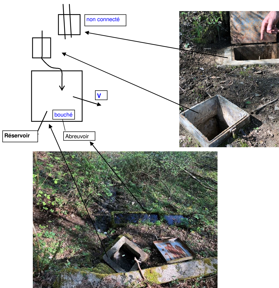
Figure 15 : représentation graphique et schématique des ouvrages de captages
