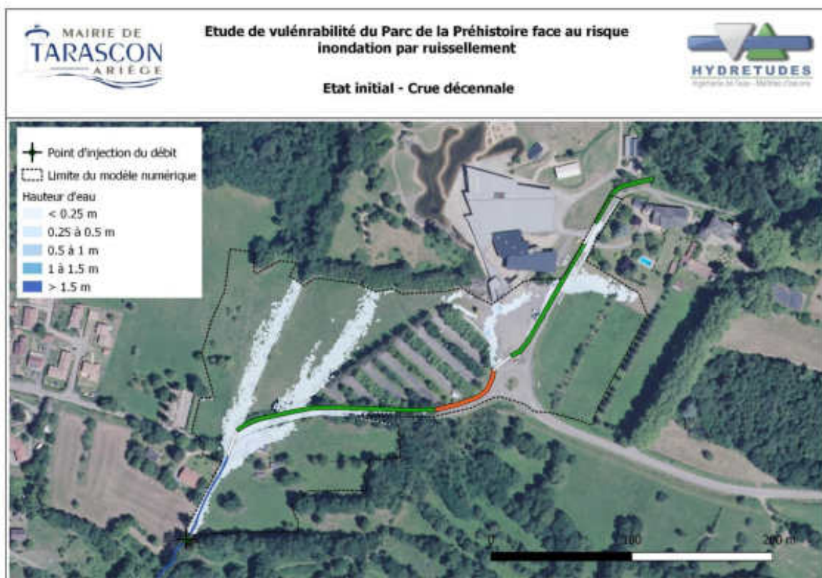
Figure 28 : Cartographie des hauteurs d'eau pour une crue décennale
