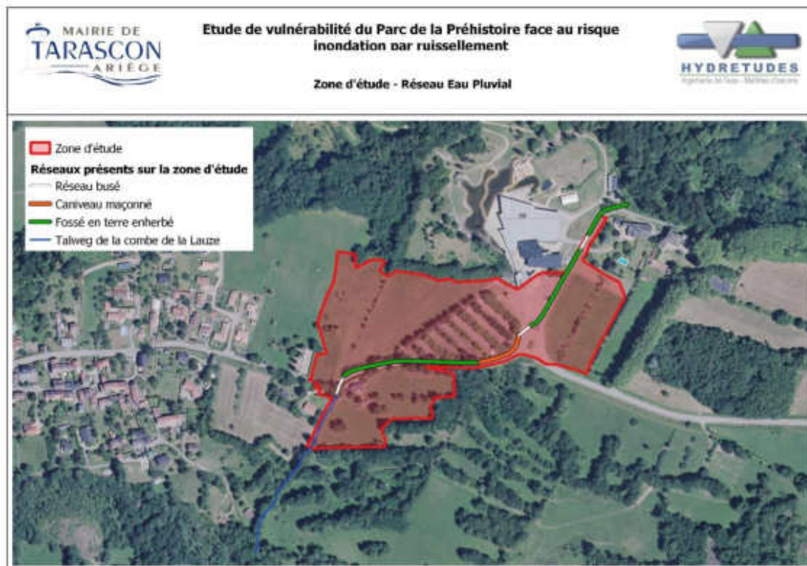
Figure 2 : Périmètre d'étude et réseau pluvial
